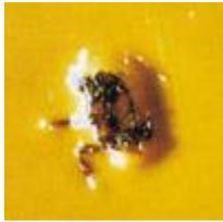
Sichtbare Verunreinigungen im Lackfilm durch Partikel unterschiedlicher Größe
