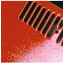
Kreisförmige Mulden mit Durchmessern von 0,5 bis 3mm. Das Erscheinungsbild reicht hier von sehr flachen Mulden in der letzten Lackierschicht bis zu gravierenden Benetzungsstörungen
