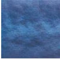
Wolkige oder streifenförmige Unregelmäßigkeiten in Metallic-Lackierungen durch ungleichmäßige Orientierung der Metallpigmente
