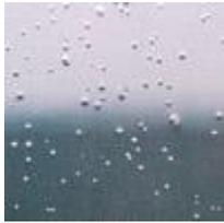
Kleine, blasenähnliche Oberflächestörungen, entstanden durch im Lackfilm eingeschlossene Lösemittel
