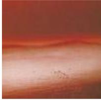
Eingefallene Lackoberfläche über Spachtel- oder Füllerstellen, mit erkennbarer Randzone, Glanzverlust (Schleier) innerhalb der fehlerhaften Zone
