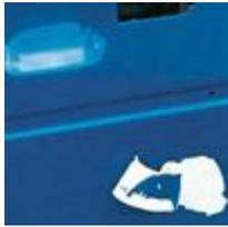
Es gibt zwei Arten von Haftungsverlust: Haftungsverlust zwischen den einzelnen Schichten einer Lackierung und Haftungsverlust zwischen dem kompletten Lackaufbau und dem Untergrund.
